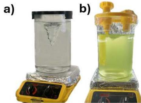
Las condiciones de mezclado son notoriamente diferentes para ambos sistemas según lo ilustrado por la Fig 1. donde en a) la formación de vórtice es característico en el flujo laminar lo cual puede afectar en los patrones de mezclado de microalgas y de nutrientes del medio a diferencia de b) donde el vórtice es de menor tamaño afectando posiblemente en el parámetro de turbulencia del reactor mejorando el mezclado con respecto a cuando el deflector no está presente a) (Acuña Torres, 2012)
